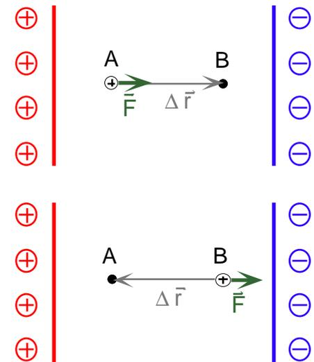
Se tivermos a mesma carga eléctrica nas duas placas, a resultante das forças aplicadas sobre a carga de prova é nula. Então a diferença de potencial entre A e B é nula. Por isso é *necessário* haver um excesso de carga numa placa em relação à outra para que exista uma diferença de potencial diferente de zero.
