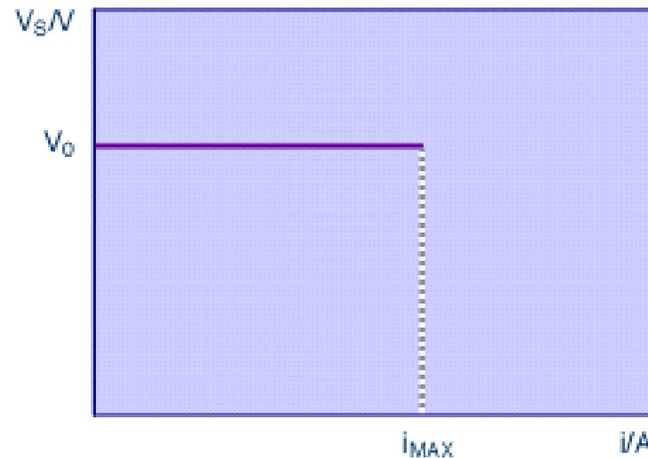
A ddp de saída mantém-se constante para qualquer valor de intensidade de corrente, até atingir o valor máximo de corrente que a fonte consegue fornecer. A partir desta intensidade ( $i_{MAX}$ ) a tensão de saída reduz-se a zero Volt.
