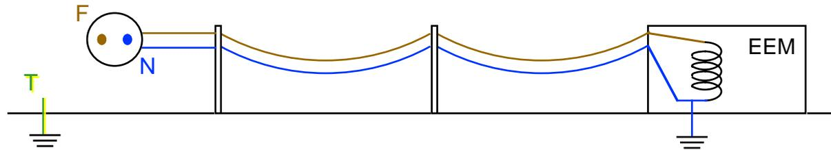
Como estamos em geral em contacto físico com a terra local é possível apanharmos um choque eléctrico se tocarmos na saída neutro de uma tomada. Para nos protegermos de possíveis choques os nossos aparelhos domésticos têm o seu revestimento ligado à nossa terra.
