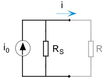
A corrente eléctrica produzida pela fonte de corrente encontra um divisor de corrente formado por duas resistências:  $R_s$  e  $R$ . A resistência  $R_s$  tem por isso aos seus extremos uma ddp (que vamos chamar  $V_s$ ). É também atravessada por uma corrente cuja intensidade é:
