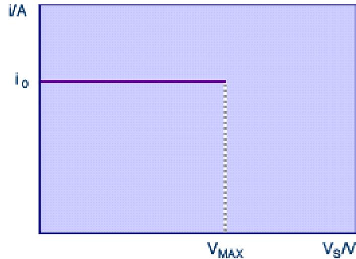
A intensidade da corrente mantém-se constante para qualquer valor de ddp, até atingir o valor máximo de ddp que a fonte consegue estar sujeita. A partir desta ddp ( $V_{MAX}$ ) a intensidade da corrente fornecida reduz-se a zero Ampere.
