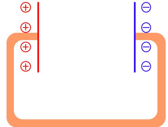
Em qualquer ponto do fio metálico podemos definir como *corrente eléctrica* a quantidade de carga eléctrica transportada através da secção de fio transversal a esse ponto por unidade de tempo.
