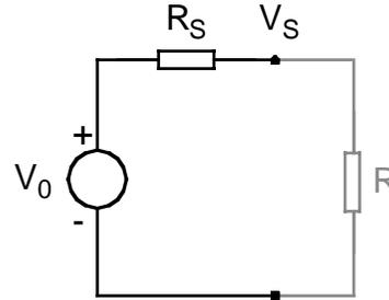
À ddp aos extremos a resistência  $R$  chama-se  $V_s$ . Se convencionamos que o lado “-” da fonte de tensão está a um potencial nulo, então a ddp aos extremos de  $R_s$  é  $V_0 - V_s$ . Aplicando a lei de Ohm, a corrente ( $i$ ) que percorre o circuito é:
