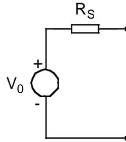
é equivalente a uma fonte de tensão real (na região linear).  $R_S$  é a *resistência de saída* ou *resistência interna* da fonte de tensão. Então uma *fonte de tensão ideal* tem uma *resistência de saída nula* e  $V_S = V_0$ .
