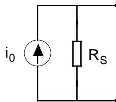
é equivalente a uma fonte de corrente real (na região linear).  $R_s$  é a *resistência de saída* ou *resistência interna* da fonte de corrente.
