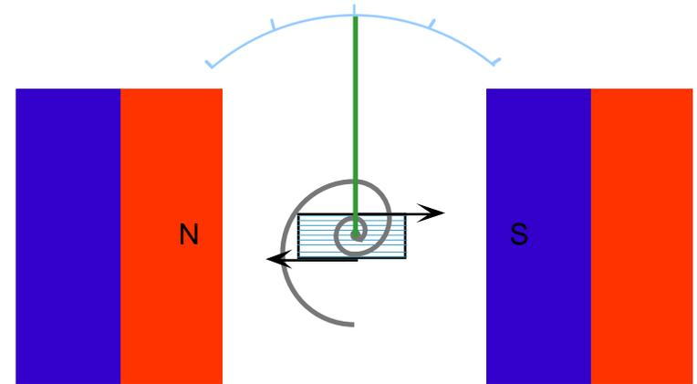
Basta-nos então proceder à calibração do aparelho. Fixamos um ponteiro ao solenoide de forma a que este ponteiro deslize sobre uma escala graduada. Esta graduação poderá ser construída a partir de uma fonte de corrente padrão.
