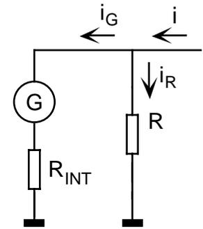
Esta é uma das características pretendidas do amperímetro. Mais, se a escala máxima deve ir até 200 mA, então quando a intensidade da corrente à entrada for  $i = 250$  mA (margem de segurança de 50 mA), devemos ter  $i_G = 50 \mu\text{A}$  (se for esta a corrente máxima permitida). A partir das equações anteriores podemos deduzir que:
