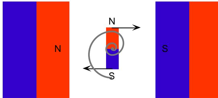
Temos um campo magnético constante criado entre os dois ímanes maiores. Imerso neste campo está outro íman que será actuado por um binário. Ao centro de rotação do íman está fixa uma extremidade de uma mola de torção e ele pode por isso rodar em torno desse eixo. A outra extremidade da mola de torção está fixa e imóvel.
