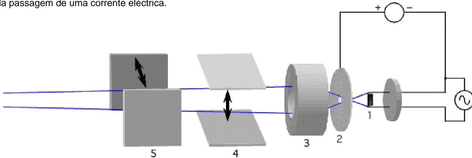
Esse filamento, ao aquecer fica com uma nuvem electrónica em seu redor. Os electrões têm um movimento caótico à volta do filamento. Entre o filamento 1 e a placa 2 é estabelecida uma ddp muito elevada (da ordem dos KV) de forma que a placa (ânodo) fica com carga mais positiva que o filamento (cátodo). O resultado é que alguns dos electrões do filamento são acelerados em direcção ao ânodo. Na figura está representada a azul a trajectória mais divergente possível para os electrões.
