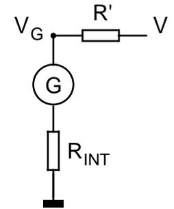
Para o potencial de 1,2 V (margem de segurança de 0,2 V) pretendemos que passe através do galvanómetro uma corrente eléctrica cuja intensidade é  $50 \mu V$ . Se aplicarmos estes dados na expressão anterior obtemos:
