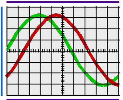
O padrão visto no primeiro varrimento está representado a verde. Antes que a oscilação da ddp seja completa o ponto luminoso atinge a extremidade direita do écran. Ao passar instantaneamente para o início do écran, o potencial continua a sua oscilação, logo a posição vertical do ponto nesse instante mantém-se. Aparece a oscilação representada a vermelho. Como os varrimentos prosseguem indefinidamente e fazem-se a grande velocidade, a imagem que aparece é:
