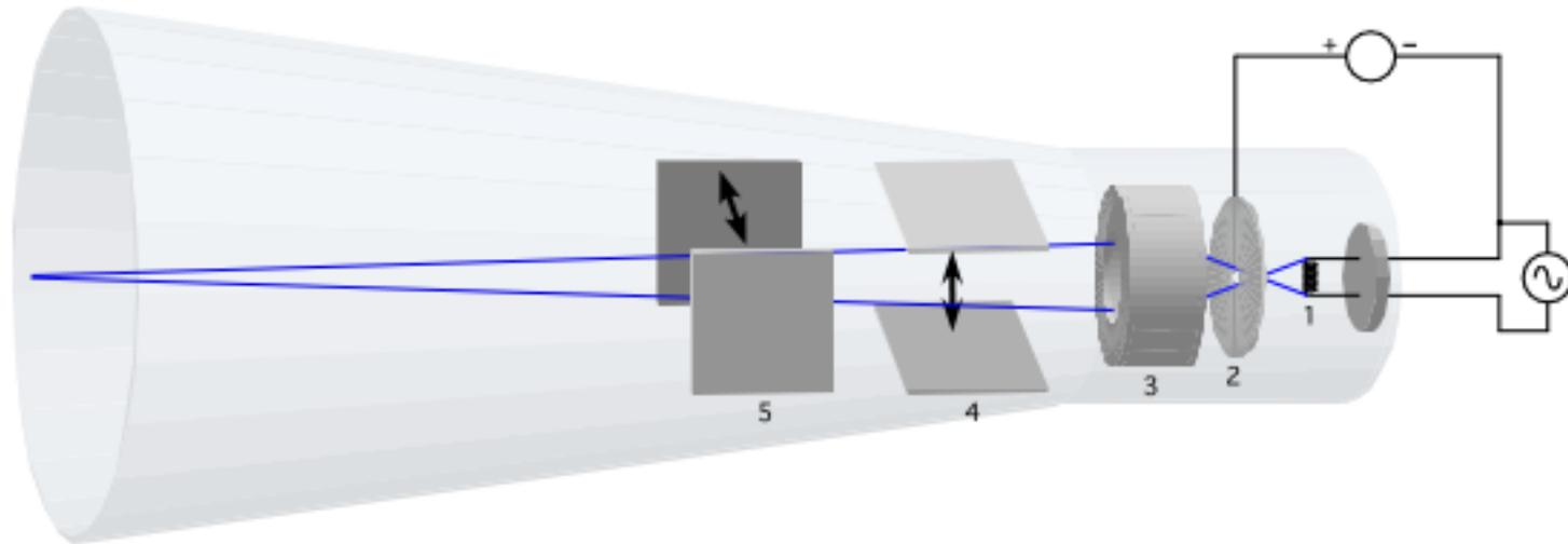
Vejam os detalhes da constituição do tubo de raios catódicos (TRC). Em 1 temos um filamento que é aquecido por acção da passagem de uma corrente eléctrica.
