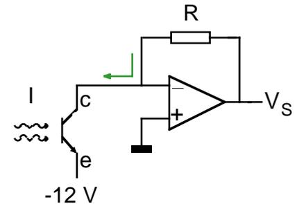
Ou seja, o potencial de saída é directamente proporcional à intensidade luminosa que incide sobre o fototransístor. A sensibilidade deste transdutor é dependente dos valores de R e K (característica do fototransístor).
