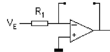
A resistência de saída do amplificador em conformação RTEC será unicamente determinada pela resistência de saída do ampop.
