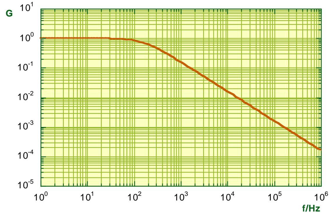
Qual é então a vantagem de utilizar um amplificador operacional? Um filtro passa-baixo ideal seria um tal que a função de transferência seria representada por:
