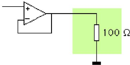
Ao colocar um seguidor de tensão na entrada aumento a resistência de entrada para um valor da ordem dos  $\text{M}\Omega$  (característica do ampop). A gora com as mesmos  $10\ \text{V}$  a corrente “pedida” passa a ser  $10\ \mu\text{A}$ .
