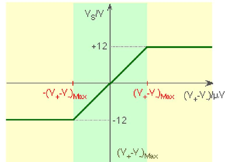
Em suma, só quando o módulo da diferença de potencial à entrada do ampop for inferior a  $12 \mu\text{V}$  ( $12 \times 10^{-6} \text{ V}$ ) é que é possível obter à saída um potencial intermédio (entre +12 e -12 V).
