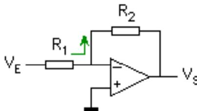
Aquilo que sabemos é que deve ser válida sempre a equação (1):  $V_s = A(V_+ - V_-)$
