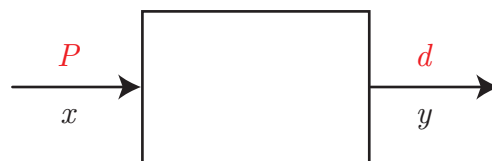
Figura 7.8: Esquema do barómetro de Torricelli como um transdutor
