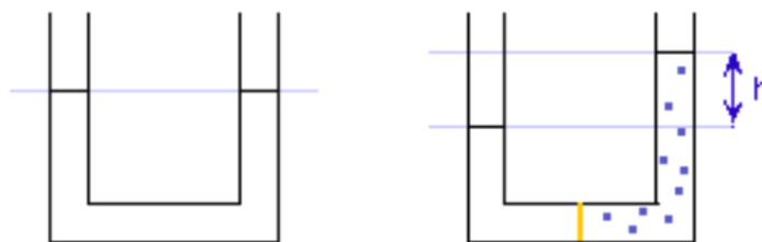
Figura 8.18: Reservatório cilíndrico separado por membrana
