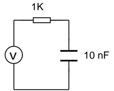
Desenhe na mesma figura a variação do potencial aos terminais do condensador.
